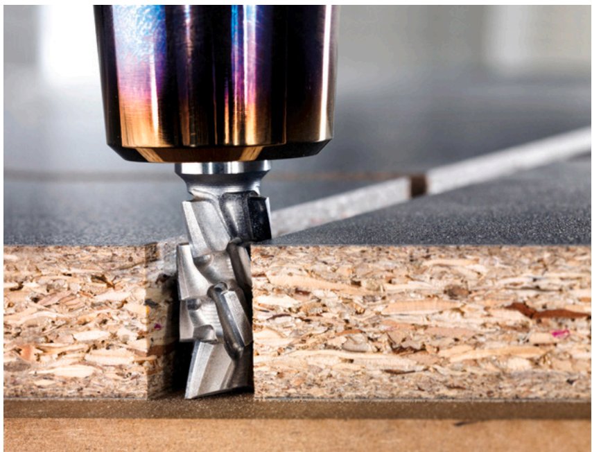
Beim Nesting empfiehlt es sich, Fräser mit kleinen Durchmessern einzusetzen. So reduziert sich das Zerspanvolumen und die Vakuumleistung am Bearbeitungstisch bleibt konstant hoch. Die Werkstücke werden somit weiter sicher am Tisch gehalten
