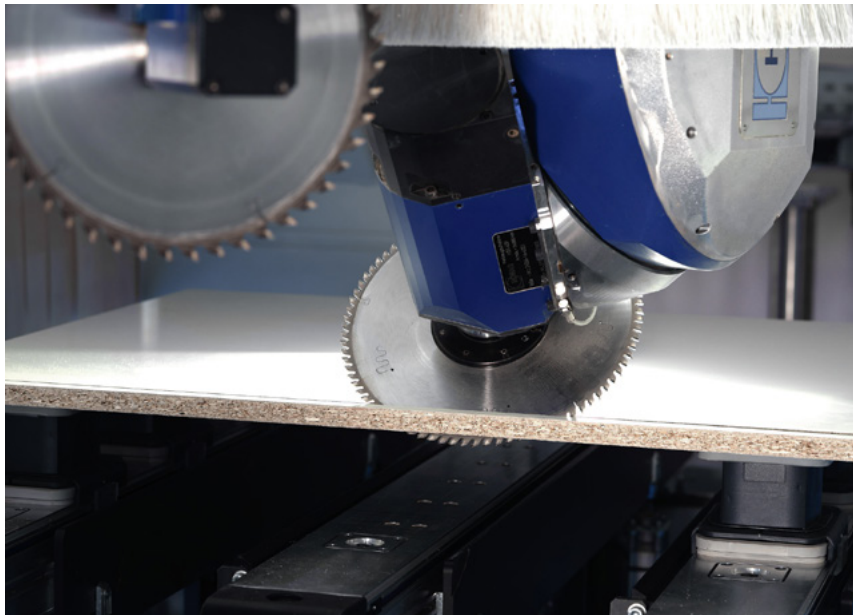
Beim Gehrungssägen auf CNC-Anlagen ist zu beachten, dass die eingesetzten Kreissägeblätter auch wirklich für derartige Anwendungen geeignet sind und welche Bearbeitungsstrategie zum Einsatz kommt
